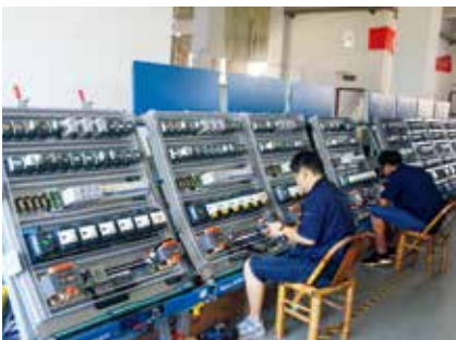
↑ 标准控制柜装配接线流水线
