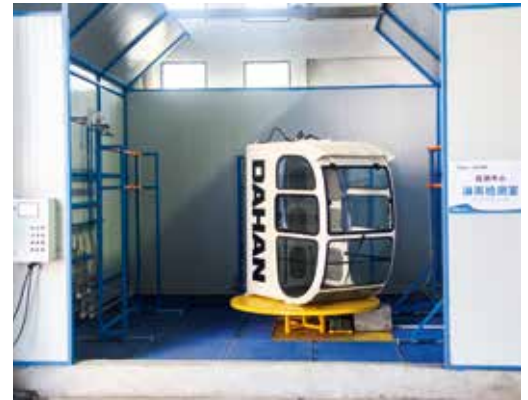
↑ 司机室喷淋试验
