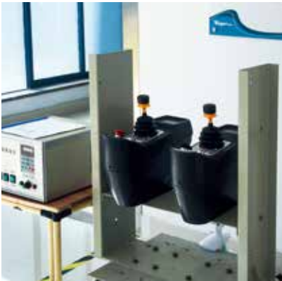
↑ 联动台防震试验
