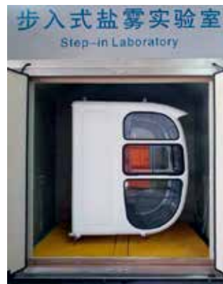
↑ 司机室整机盐雾试验
